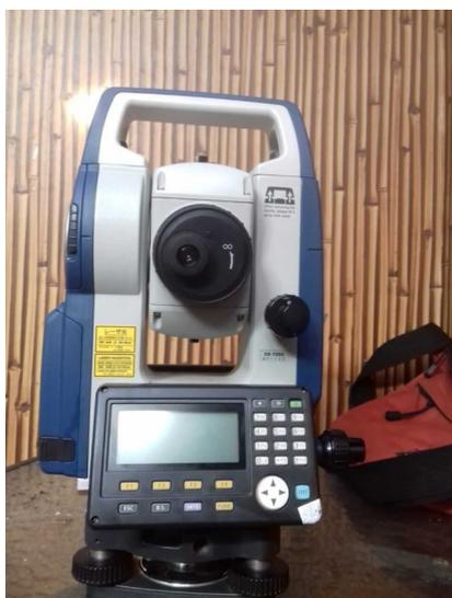
Рисунок №1 – Электронный тахеометр SOKKIA CX 105
