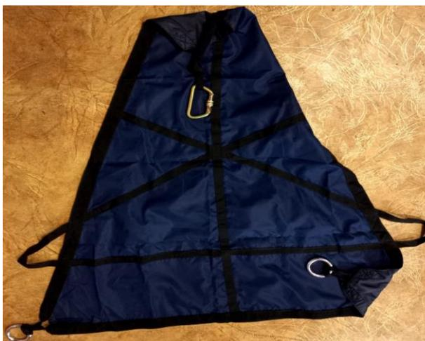
Рисунок 3: Спасательная петля косынка модернизированная
