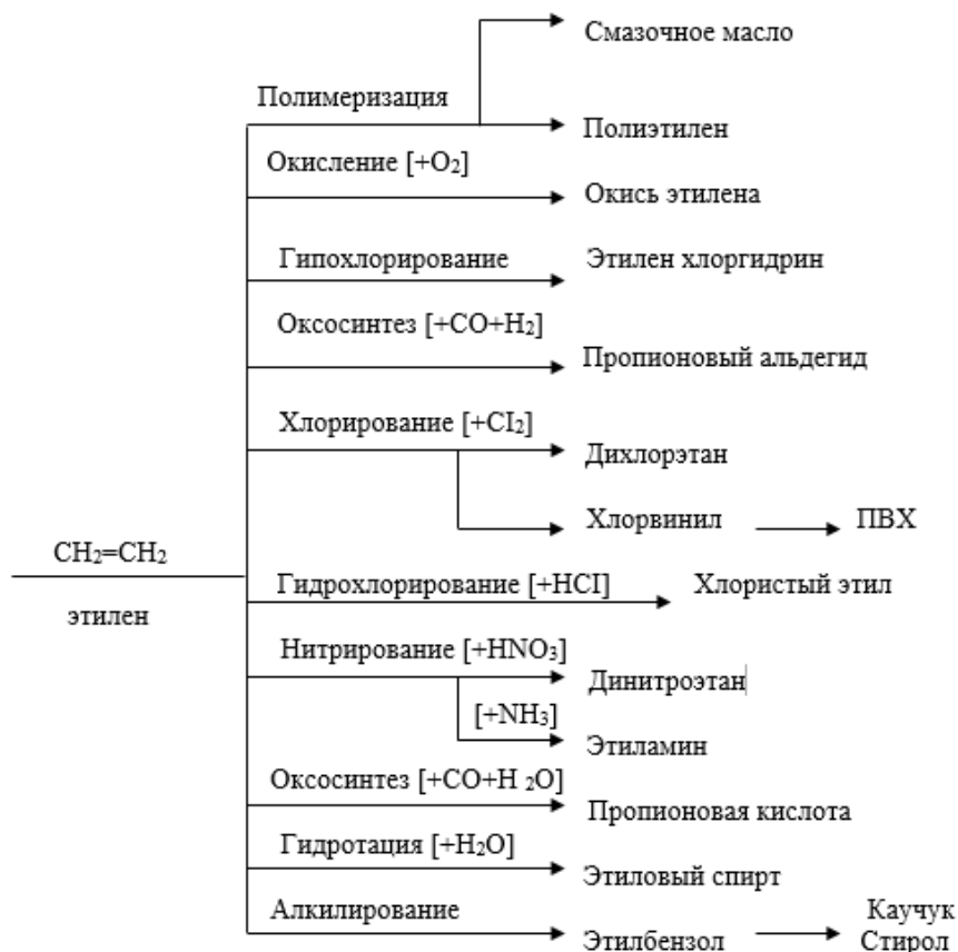
Рисунок 2 – Основные направления химической переработки этилена
