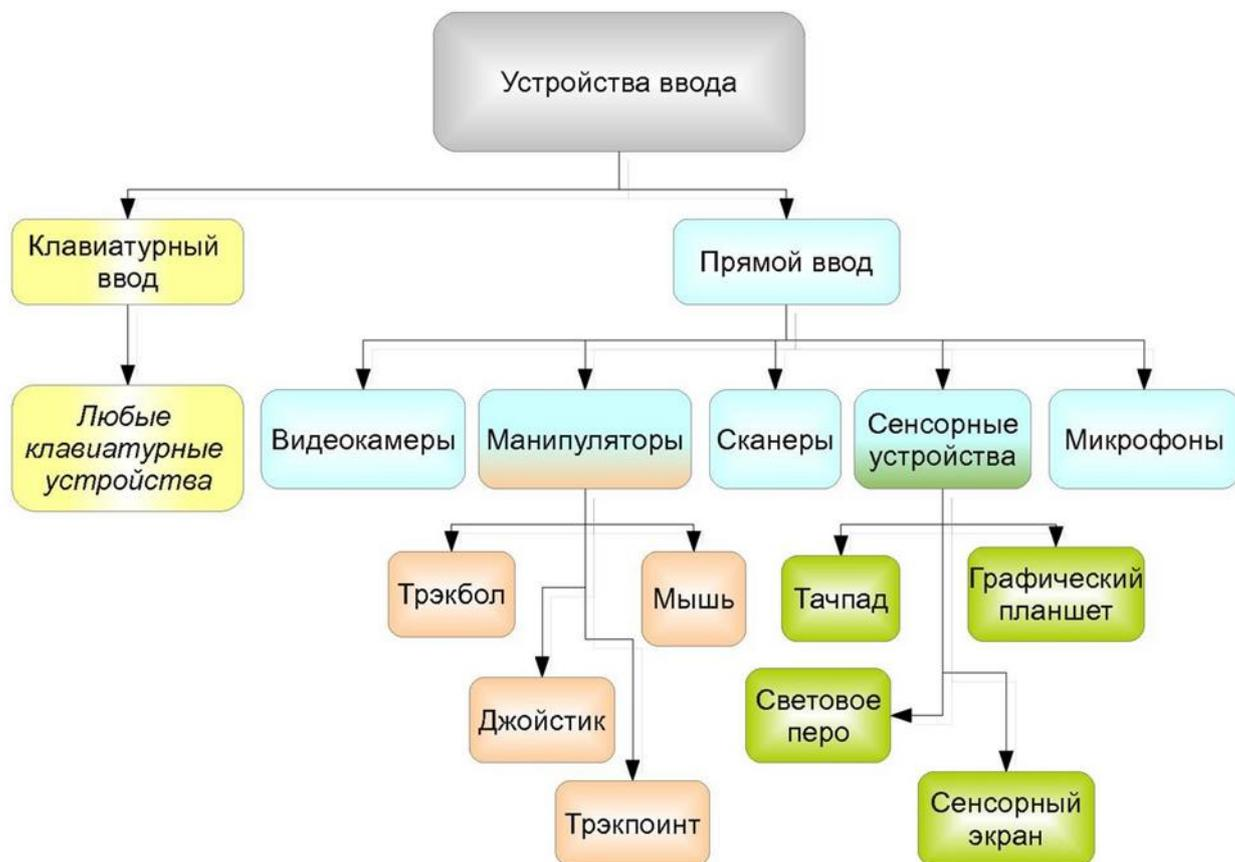
Рис. 1. – Классификация устройств ввода
