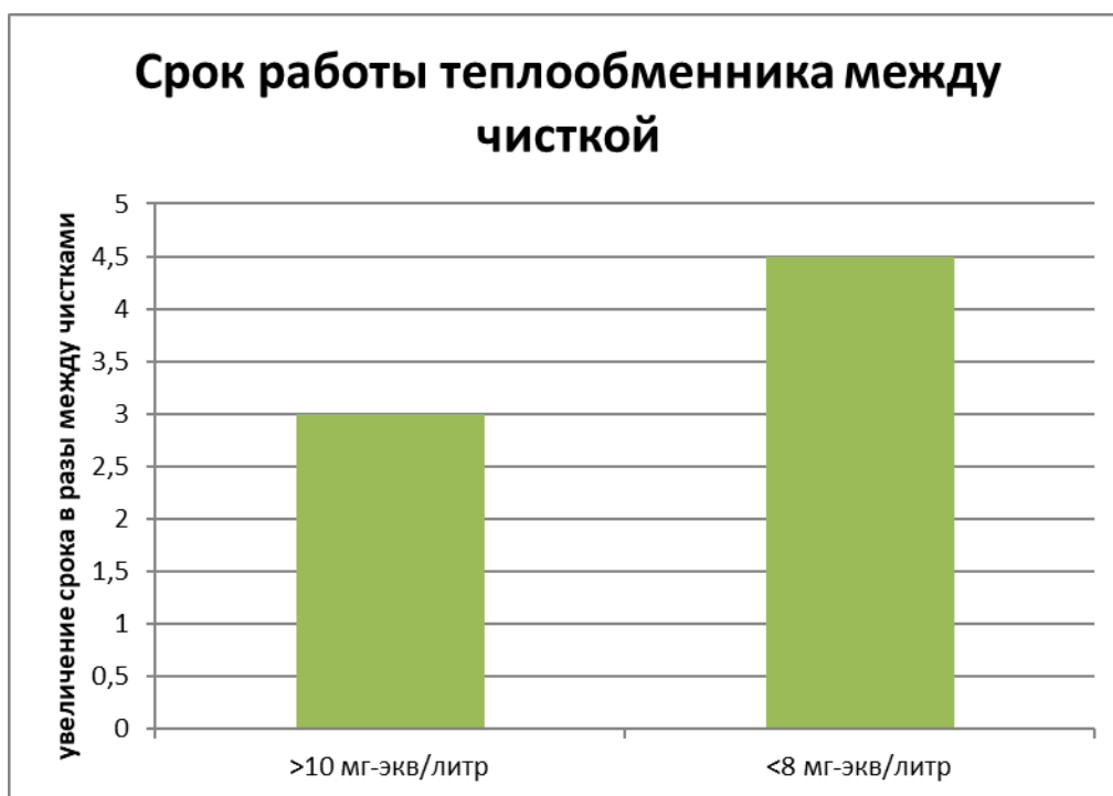
Рисунок 22 График показывающий зависимость качества воды и периодов чистки с использованием ультразвукового агрегата
