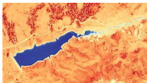
Рисунок 5. Карты индекса NDWI, используемый для определения площади Ахангаранского водохранилища по состоянию на июнь. (Рисунок сделано автором)
