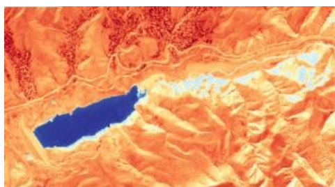
Рисунок 5. Карты индекса NDWI, используемый для определения площади Ахангаранского водохранилища по состоянию на июнь. (Рисунок сделано автором)
