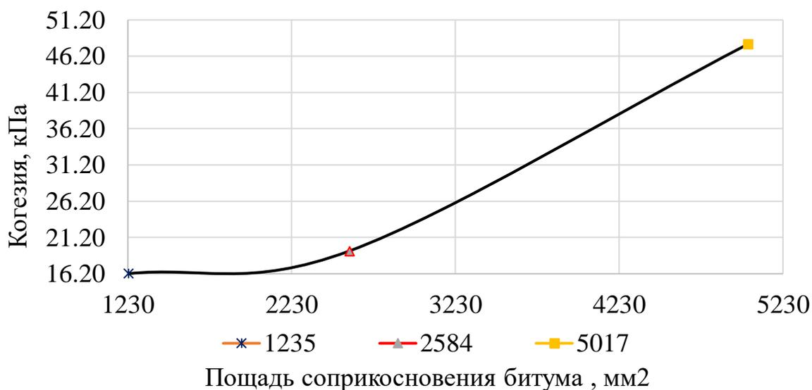
Рисунок 2 - Зависимость когезии от площади соприкосновения битума с пластиной
