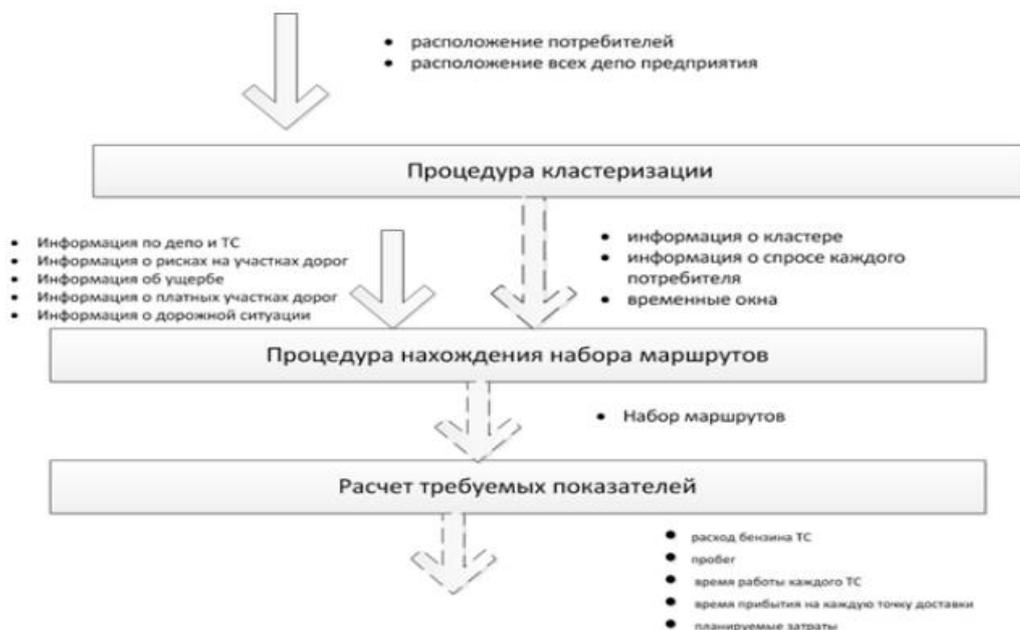
Рисунок 4 – Схема решения задачи формирования рациональных маршрутов в системе планирования транспортного режима при перевозках готовой продукции
