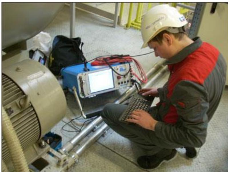
Рисунок 2. Снятие параметров тока с электродвигателя
