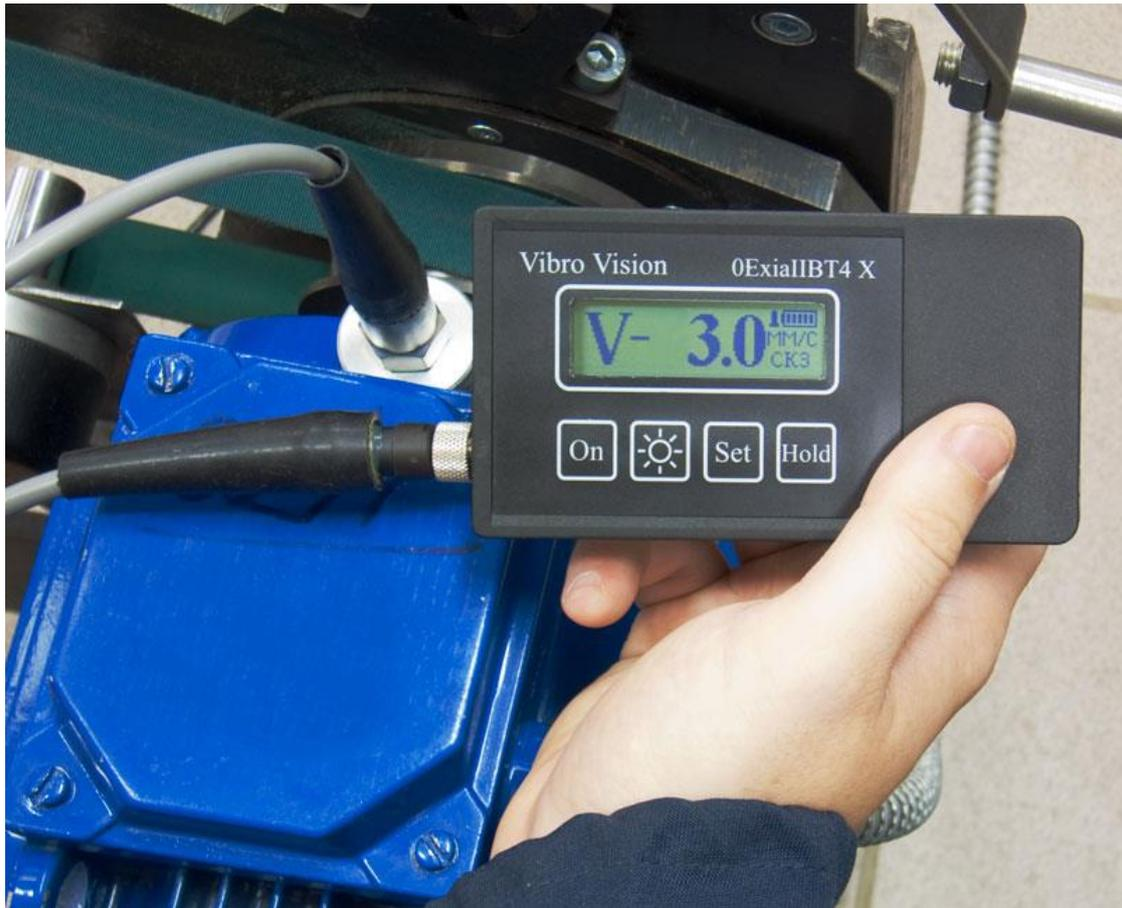
Рисунок 1. Снятие показаний вибрации на электродвигателе
