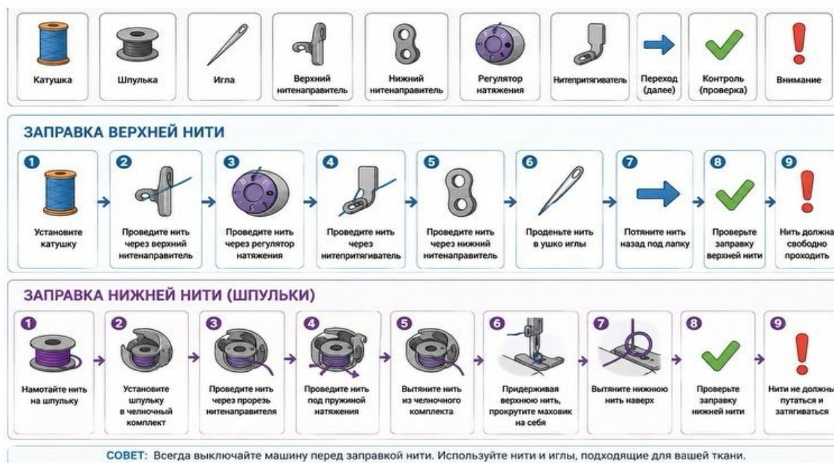
Рисунок 1 - Примеры обозначения технологических категорий и процессов инфографическими знаками по теме «Заправка верхней и нижней нити швейной машины».
