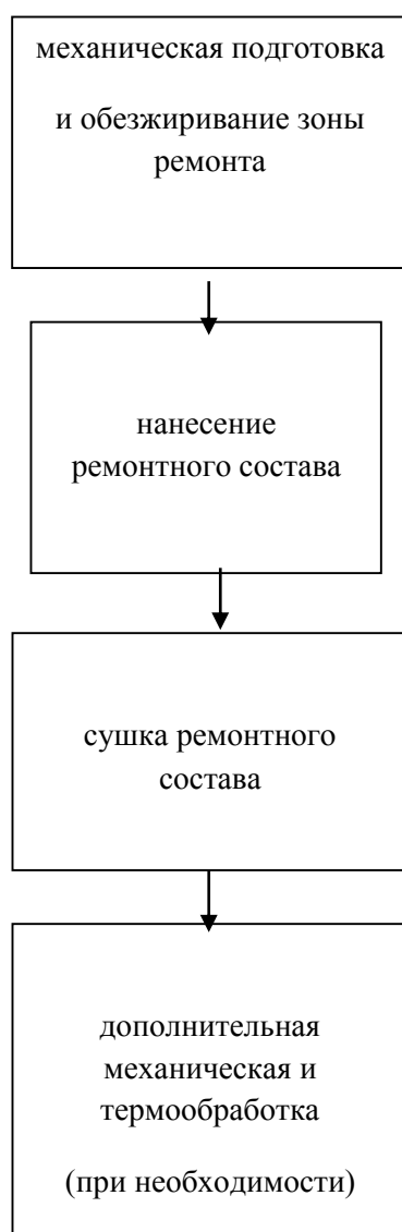
Рисунок 1 - Схема технологического процесса ремонта элементов салона автомобиля растворами большой вязкости
