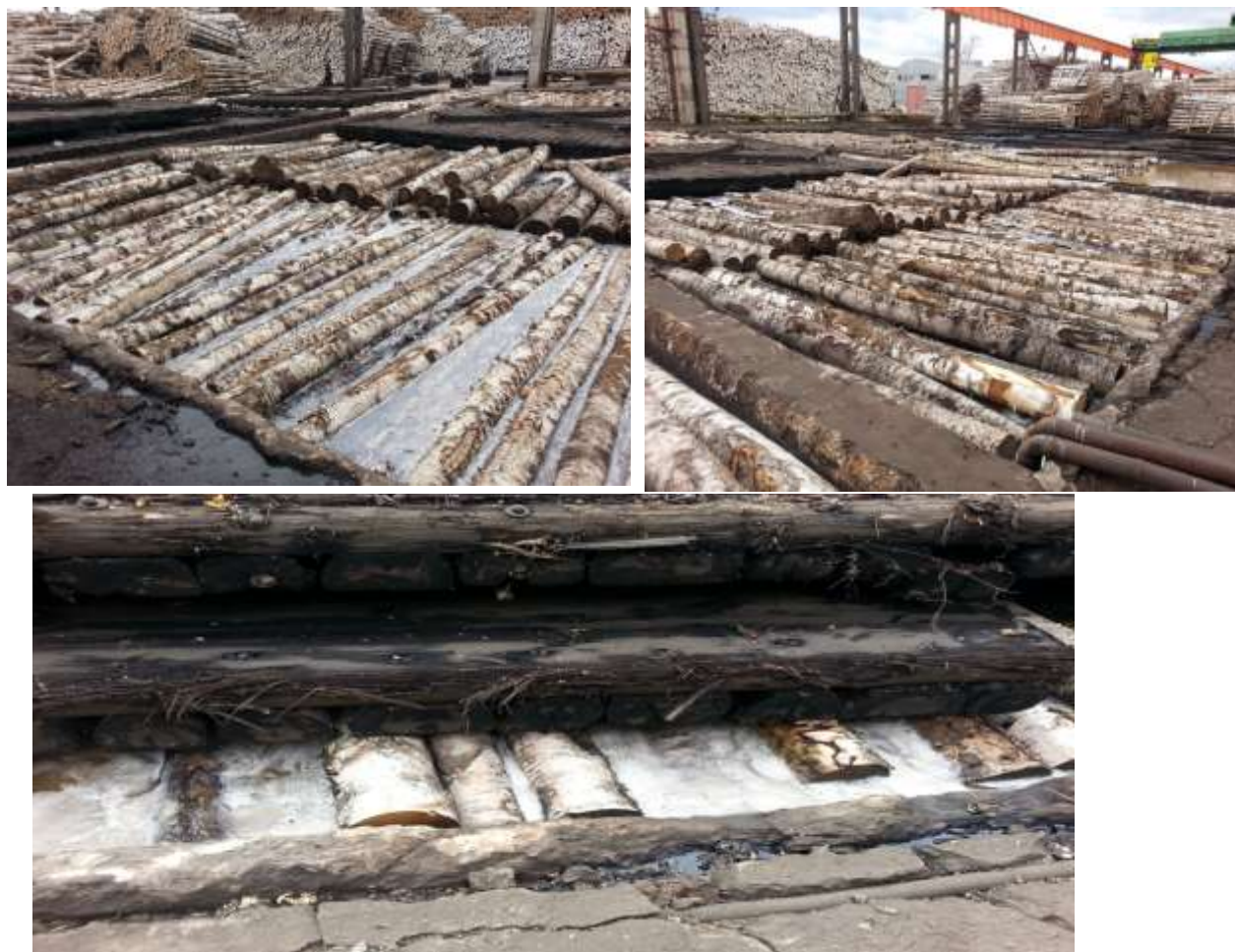
Рисунок 6 – Бассейн гидротермической обработки
