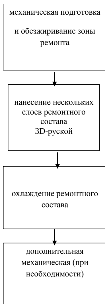
Рисунок 6 - Схема технологического процесса ремонта элементов салона автомобиля 3D-ручкой
